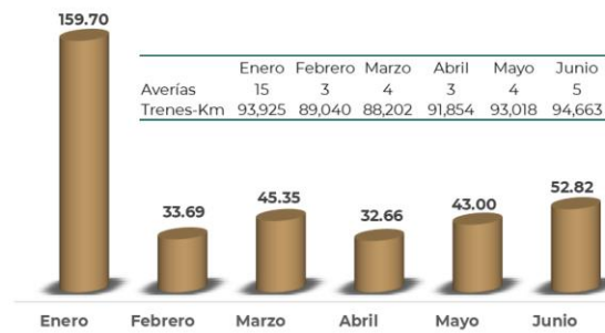
Gráfica 11. Índice de averías totales (ene-jun 2024) Fuente: Elaboración propia. Información proporcionada por la Coordinación General de Mantenimiento de Equipo Ferroviario
